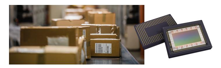
最新の物流システムでは、1次元+2次元コードを高速でスキャンすることが課題となっており、高解像度イメージャーへの移行が進んでいます。高解像度センサーの採用により、大型ベルトコンベアーに1台のみの固定カメラを設置、ベルトコンベアー全幅にわたり荷物をスキャンすることが可能になります。Snappy Wide™が採用する独自の横長ワイドフォーマットは、高価となる余剰なピクセルを回避(通常のフォーマットは、正方形または縦横比率4:3)、低コスト光学系により大幅にシステムコストが削減ができます。高性能の電気光学特性により、最高のパフォーマンスを発揮、優れた画質が取得ができます。Snappy Wide™ は超高速デュアル・ライン スキャニング用途にもご使用頂けます。
