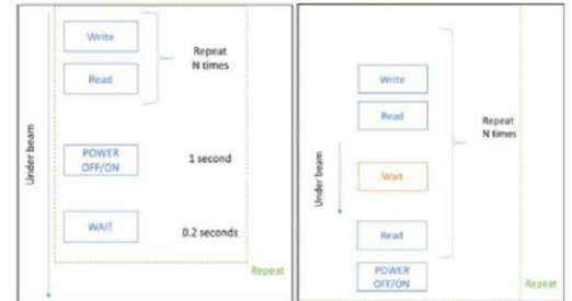
図7：動的モード（左）と静的モード（右）の試験原理
