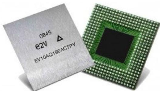
EV10AQ190 は Teledyne e2v の 10 ビットの高速 ADC で、3.2GHz のアナログ入力周波数帯域幅があり、高速・高性能のデータ取得ソリューションに最適です。内蔵のクロスポイントスイッチとマルチコア・アーキテクチャにより、デバイスを最大 1.25GSps の 4 チャンネル、最大 2.5GSps の 2 チャンネル、あるいは最大 5GSps の 1 チャンネルとダイナミックに構成することが可能です。この特性を利用すれば、Moku:Pro で複数の計測装置を ADC の異なるチャンネルに割り当てて構成し、切り替えながら利用することができます。
