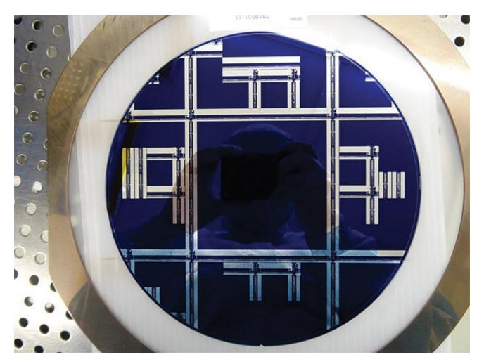
チップスケールのデバイスとは異なり、ラージフォーマットイメージングセンサーはウェーハスケールの欠陥に非常に敏感です。 センサーサプライヤーは、自動車市場で使用されているものよりもさらに厳格に製造性を考慮した設計 (design-formanufacturing) を採用することにより、これらの欠陥の潜在的な影響を軽減します。Teledyne社 提供。
