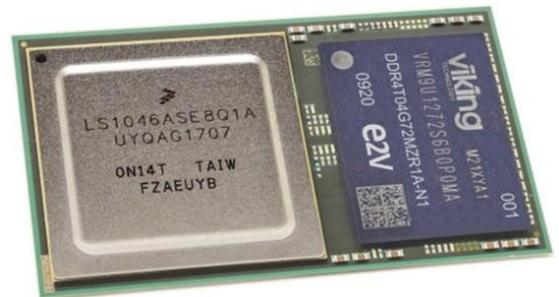
図1: Qormino® QLS1046A-4GBのプロセッサとメモリ [テレダインe2v]
