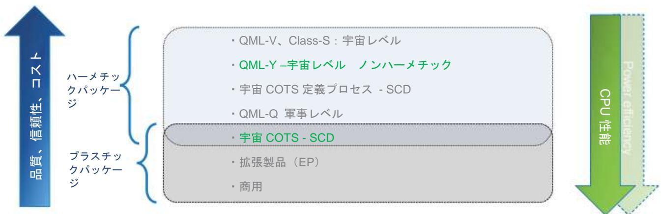
図1- 品質と信頼性要件はコストとともに上昇（プラスチックからハーメチックパッケージへ）しますが、CPU 性能は明らかに低下します。共通部分は宇宙 COTS -SCD です。
