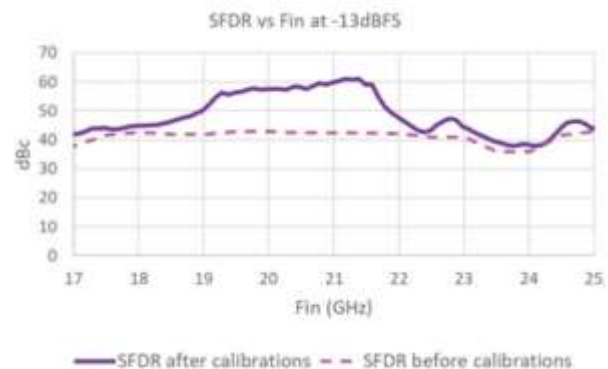
図5 - 初期の PCB ベースのプロトタイプによる校正前後の K バンド SFDR 実験結果
