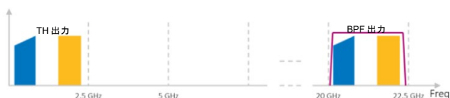
図3-受信経路TH( f_s = 5 GHz)、2.5 GHz帯域信号のサブ・サンプリング(搬送波21.25 GHz)
