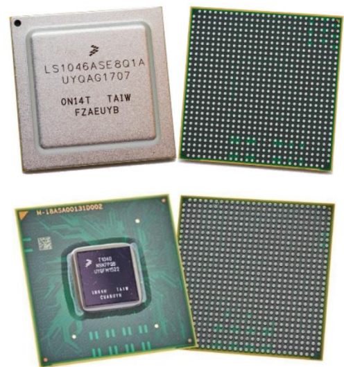
図 3：LS1046 のリッド付き設計 [上]、T1040 のリッドなし設計 [下]。
