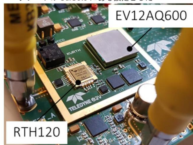
図 2 - キャリアボードに搭載した最初の FEB プロトタイプ
